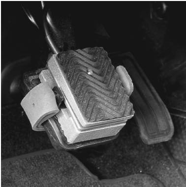
Bild 1: Am Bremspedal montierter Sensor
