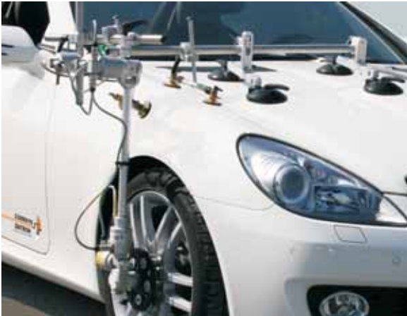
Bild 3: RV-4 Sensor, Vorderradmontage mit 4-fach Saughalter
